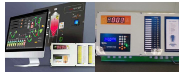
PC de contrôle, synoptiques dynamiques, logiciels de surveillance des stocks
